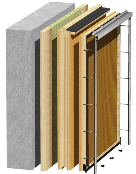
Bestand (Mauerwerk) Unterkonstruktion mit Ausgleichsdämmung BSP-Platte GAP-Paneel Befestigungsteile
